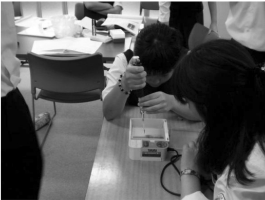
図4 電気泳動槽への DNA の注入
